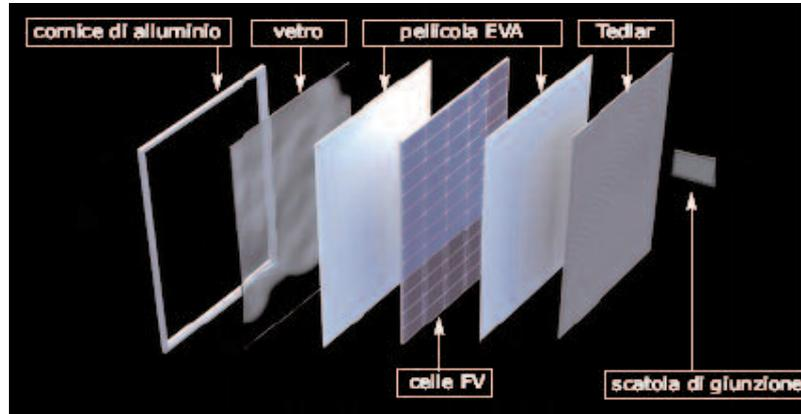
**Figura 1.** Schema funzionale indicativo di modulo fotovoltaico rigido
