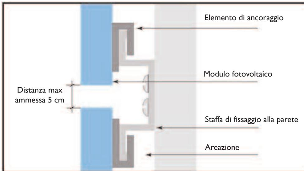
**Figura 11.** Componente speciale utilizzato per facciata ventilata
